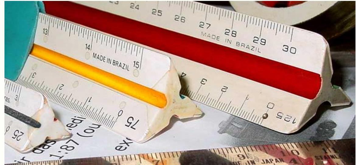
O escalímetro não deve ser utilizado no traçado de linhas. Emprega-se apenas para medições, evitando-se o desgaste das marcações das escalas. As linhas devem ser traçadas com o auxílio dos esquadros ou da régua T.
